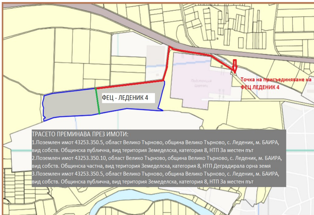
Фиг. 8 Трасе на външно кабелно захранване – Леденик 4
